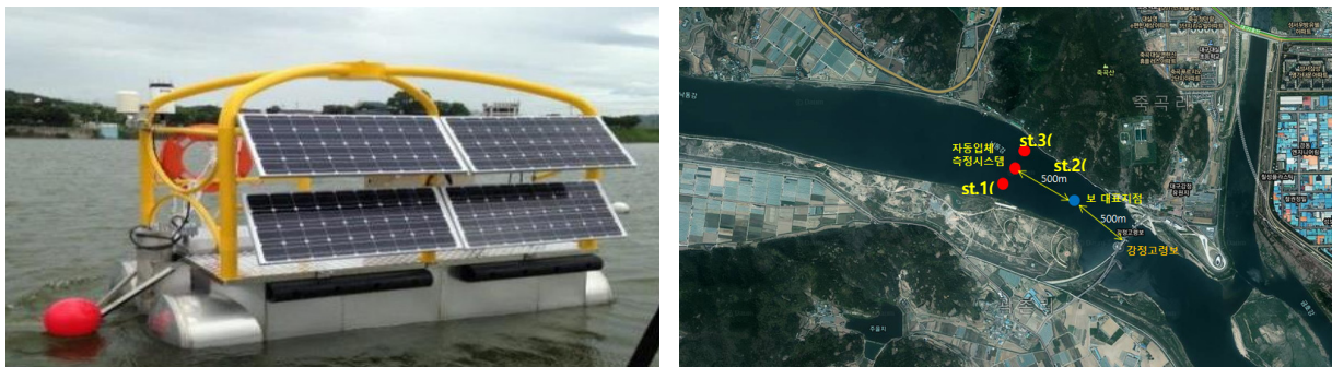
그림 3-1-1 강정고령보의 자동입체측정시스템 및 모니터링 지점
