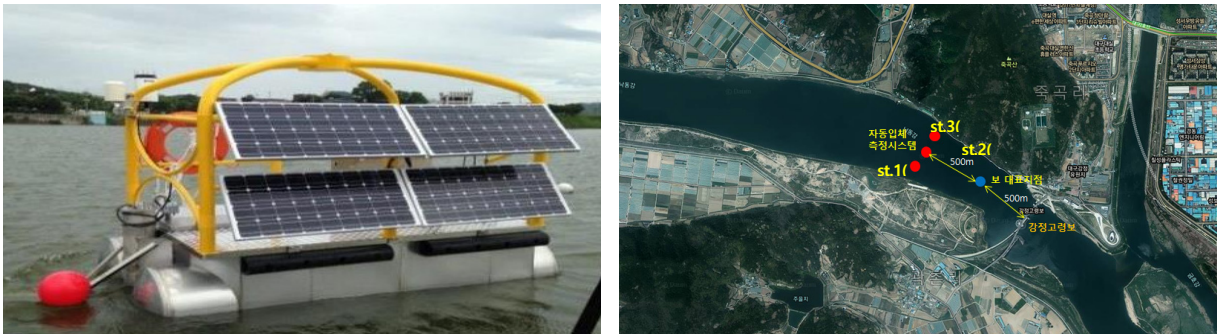
그림 3-1-1 강정고령보의 자동입체측정시스템 및 모니터링 지점
